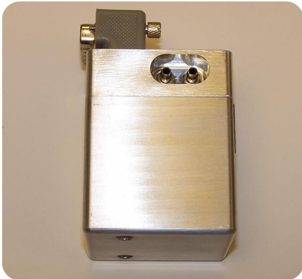
Датчик кислорода OP-2 подключается непосредственно к системе EGM-5 и измеряет концентрацию кислорода в проходящем токе воздуха. Кислородная электрохимическая
